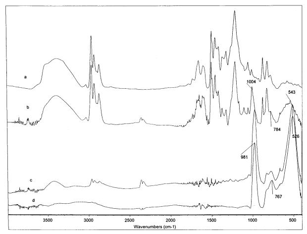
Figure 4. FTIR spectra of (a) PEP; (b) PEP/V<sub>2</sub>O<sub>5</sub> (5 wt %:95 wt %); (c) PEP/V<sub>2</sub>O<sub>5</sub> (30 wt %:70 wt %); (d) V<sub>2</sub>O<sub>5</sub>.
